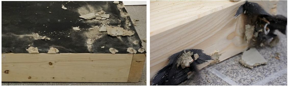
Abbildung 109: Trennung der Unterspannbahn vom Holzständerwerk (eigene Darstellung)
